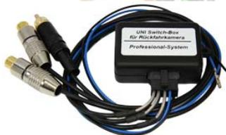
Das Interface ermöglicht den Anschluss einer Videoquelle in Verbindung mit einer Nachrüst-Rückfahrkamera. Der zusätzliche Videoeingang ist permanent aktiv, wird aber wie original beim einlegen des Rückwärtsganges auf die Rückfahrkamera geschaltet. Interface kann direkt an das Rückfahrlicht oder in Verbindung mit can-unir verbaut werden.
