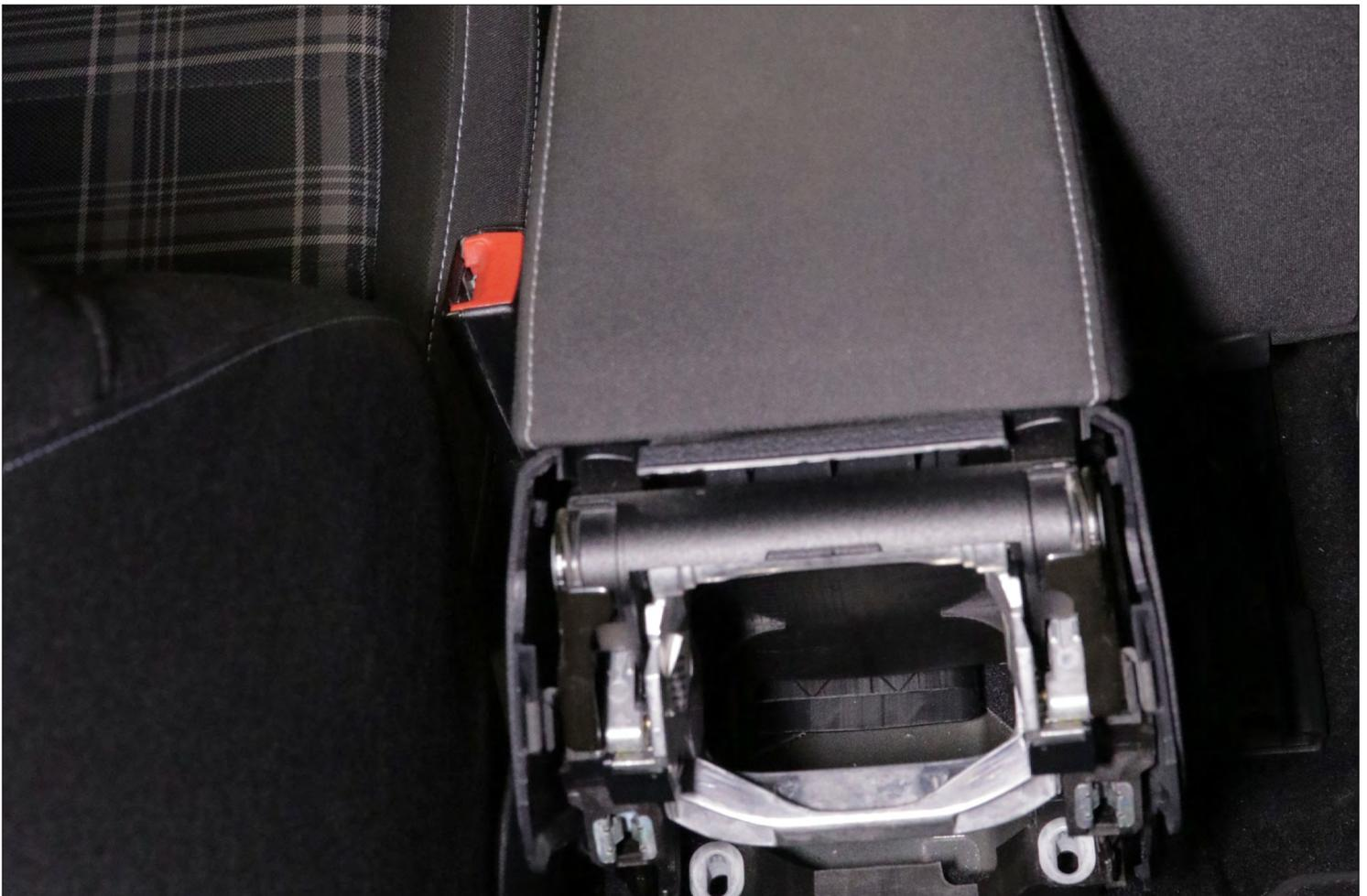
Ziehen Sie die gesamte Konsole nach oben (von hinten) und ziehen Sie den Stecker von der +12V Buchse ab.
