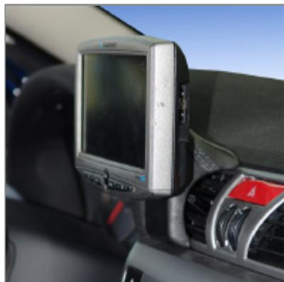
Luchtrooster met bevestigede Konsole weer monteren
