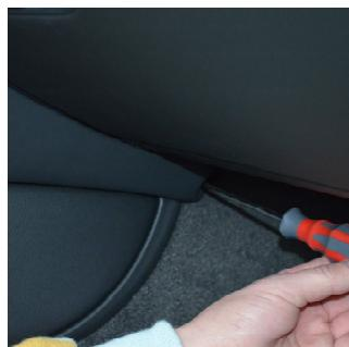
Vissez la vis jointe dans la partie inférieure de la console
