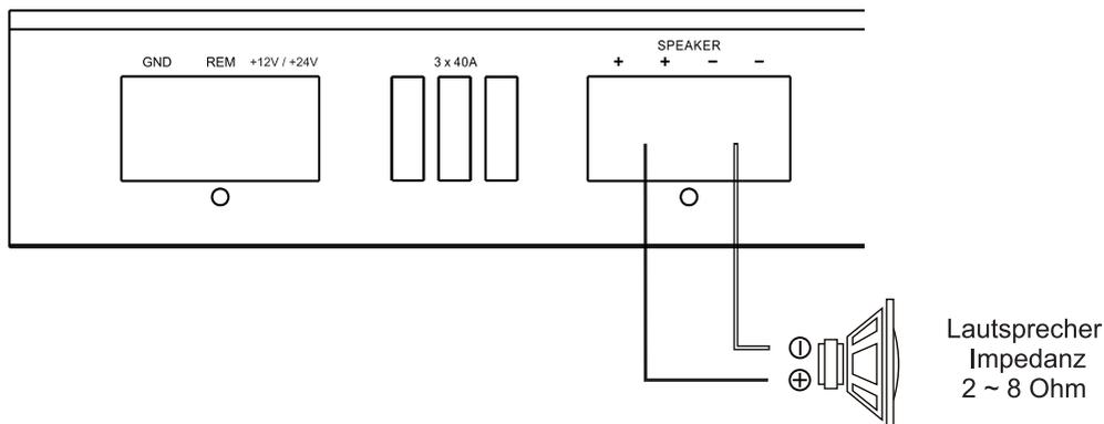
Bitte beachten Sie, dass die **R-850.1** ein reiner Mono-Verstärker ist. Beim Anschluss von 2 Lautsprechern oder einem Doppelschwingspulen-Subwoofer werden die Lautsprecher (Schwingspulen) parallel geschaltet. Dabei ist zu beachten, dass jede Spule nicht weniger als 4 Ohm besitzt. Die Gesamtimpedanz beträgt dann 2 Ohm.
