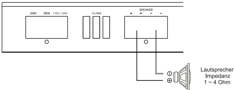
Bitte beachten Sie, dass die **R-1250.1 D / R 1250.1 D 24V** ein reiner Mono-Verstärker ist. Beim Anschluss von 2 Lautsprechern oder einem Doppelschwingspulen-Subwoofer werden die Lautsprecher (Schwingspulen) parallel geschaltet. Dabei ist zu beachten, dass jede Spule nicht weniger als 2 Ohm besitzt. Die Gesamtimpedanz beträgt dann 1 Ohm.
