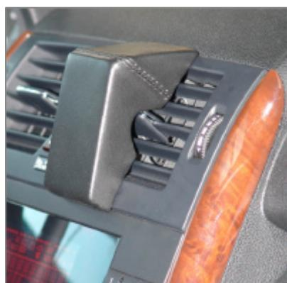
Montez de nouveau la grille de buse d'aération avec la console de navigation déjà installée
