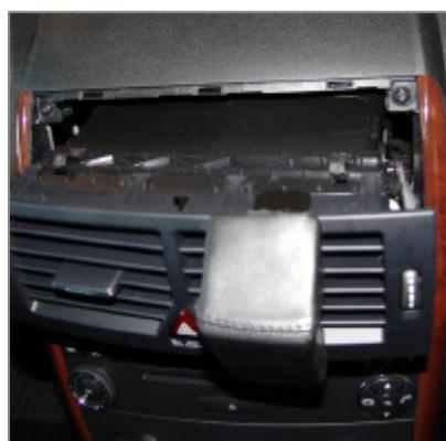
Positionnez la console sur la grille de buse d'aération
