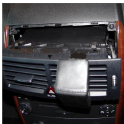
Konsole auf dem Lüftungsgitter positionieren
