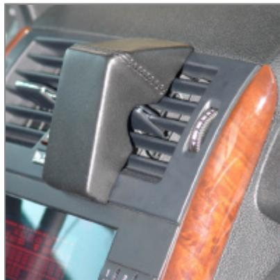
Lüftungsgitter mit montierter Navigationskonsole wieder einsetzen
